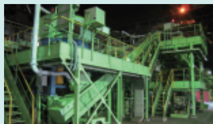
ニッケル再資源化施設「ブリケット製造設備」
