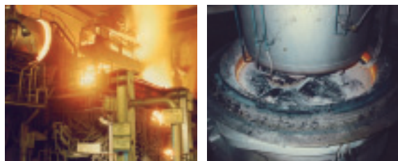
複合製鋼プロセスの80トン電気炉(左)、真空脱ガス装置(右)
